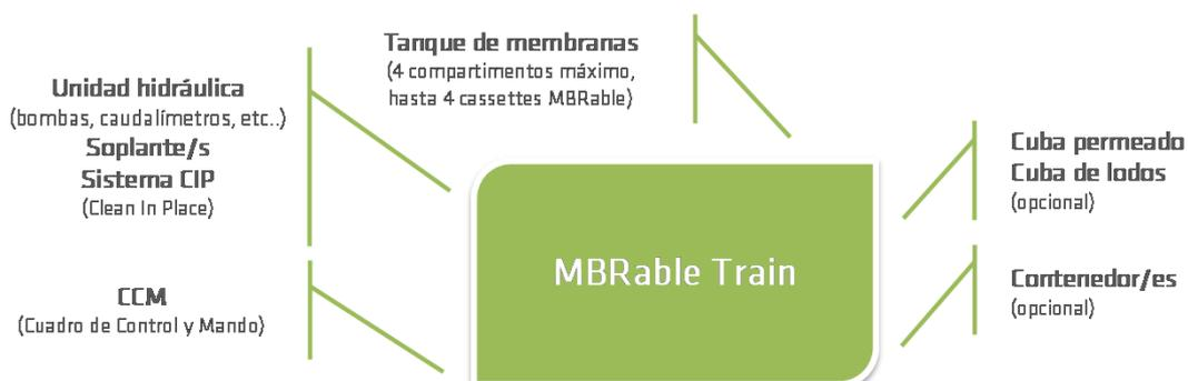
Se puede suministrar con o sin cubas, montado en contenedor, con el panel de bombas en intemperie o en contenedor, etc. para que sea fácilmente transportable tanto por vía terrestre como marítima y se pueda conectar y poner en funcionamiento prácticamente al instante.
